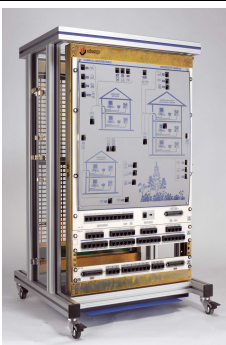
Système de télécommunication (PABX) et réseau informatique de PME : téléphonie analogique et numérique
