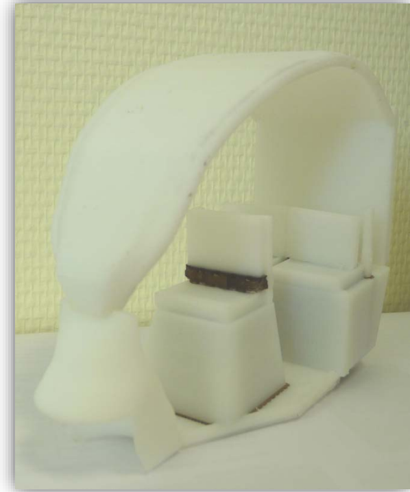
Maquette par impression 3D pour essai aérodynamique (soufflerie ENSAM Angers)
